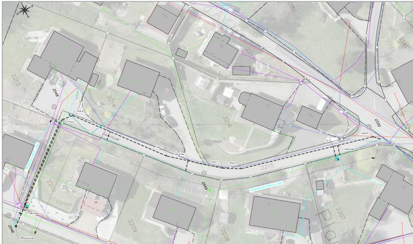
Le quartier de la Gîte à Le Bry fait partie des priorités hautes en ce qui concerne le remplacement des conduites anciennes. Les travaux permettront de mettre le réseau aux normes et ainsi d'éviter des travaux de réparation imprévus.
